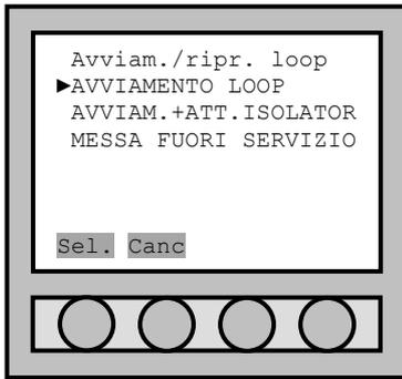
Il menù "Avviam./ripr. loop" prevede due modalità di avviamento o ripristino loop e la possibilità di mettere fuori servizio il loop stesso (operazione necessaria in caso di manutenzione).
