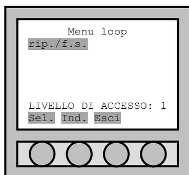
Entrati nel "Menù loop" si trova la voce: "rip./f.s." (ripristino / fuori servizio). Utilizzando le quattro frecce poste sotto il display è possibile selezionare la scelta e confermarla premendo "sel.". Per il primo avviamento del LOOP e ogni volta che è necessario il riavvio del loop, va selezionato "rip./f.s.".
