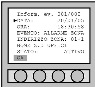
Visualizzazione del dettaglio di un messaggio (in questo caso abbiamo un evento di tipo allarme zona).
