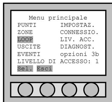
La procedura di avviamento di ogni loop va eseguita una sola volta. Entrare al "Menù principale" e selezionare "LOOP" utilizzando le quattro frecce poste sotto il display (vedi "come selezionare una scelta dal menù della centrale"). Confermare con "sel." la scelta effettuata per passare al "Menù loop".
